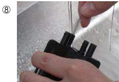
⑧ 出口の部分にもカスが固着している 可能性がありますので清掃用ブラシで清 掃します。
