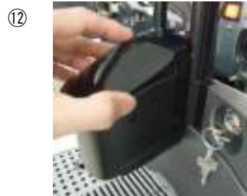
⑫ 抽出ノズルカバーを取り付けます。 手前から奥にスライドさせ取り付けます。
