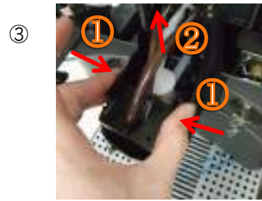
③ 1. 抽出口上部のつまみを矢印の方向へ つまみます。 2. 抽出口を上方向へ引き上げます。
