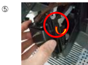
⑤ 抽出口 TOP カバーの丸印の部分の 引っ掛けを少し広げて外します。 (注) 広げすぎると折れる場合があるため注 意します。
